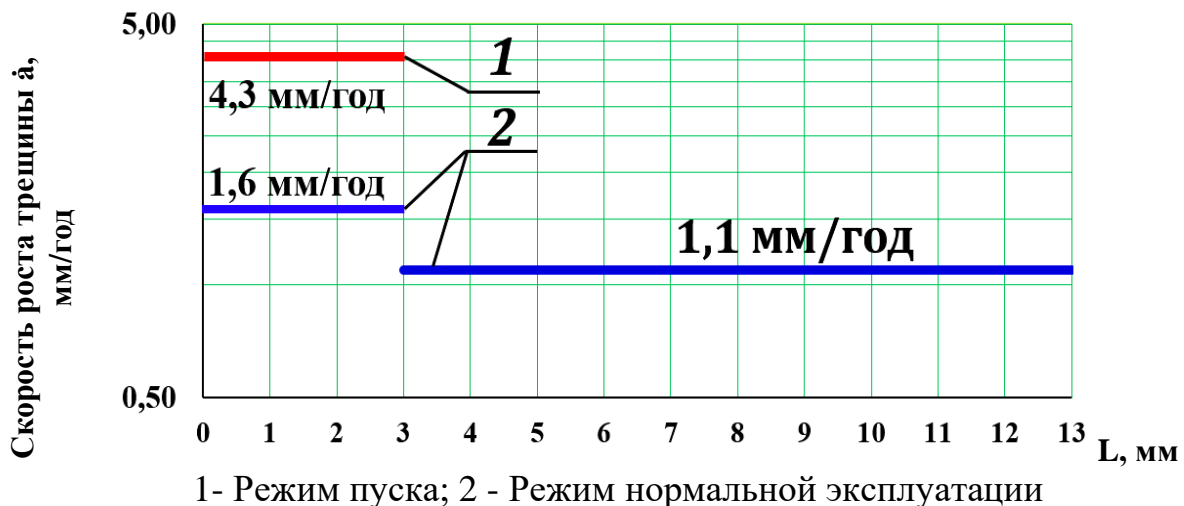
Рисунок 9 – Расчетная оценка скорости трещины МКР в глубину в металле околошовной зоны по толщине стенки трубопровода Ду300
